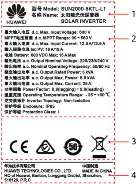
Figura 2-6 Placa de identificação (usando o SUN2000-5KTL-L1 como exemplo)
